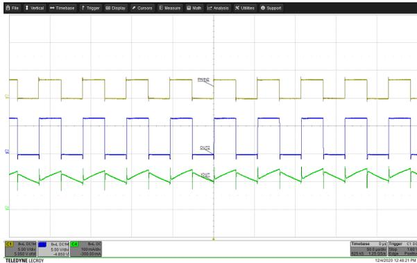
A. 通道 1 = IN2 通道 2 = V<sub>OUT2</sub> 通道 4 = 电机电流
