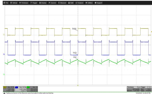
A. 通道 1 = IN2 通道 2 = V<sub>OUT2</sub> 通道 4 = 电机电流
